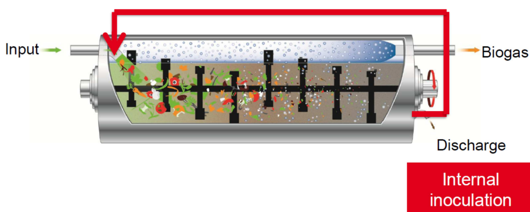
Figura 10 – Schema del sistema di inoculazione interno al digestore
